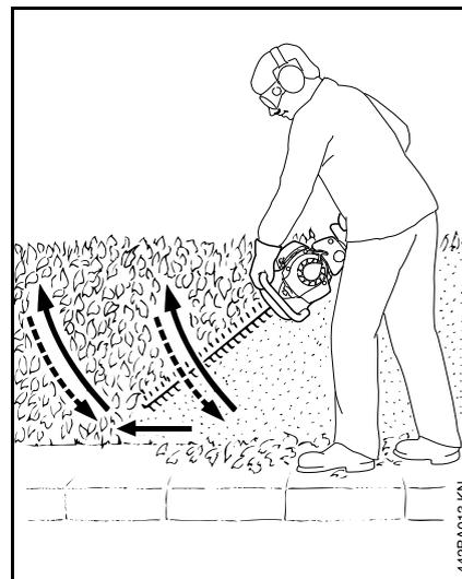
Guiar el cortasetos hacia arriba y abajo en forma de arco – bajar y seguir hacia delante – y volver a guiar las cuchillas hacia arriba en forma de arco.
