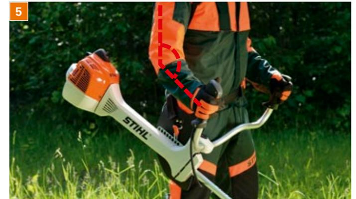
El ángulo de corte óptimo se obtiene automáticamente con el equilibrado de la máquina. Las desbrozadoras STIHL a partir de la FS 310 están equipadas con un cómodo ajuste de la empuñadura que no necesita herramientas. La desbrozadora está correctamente colocada cuando el ángulo del brazo doblado es de aprox. 120 grados y las muñecas están rectas (5).
