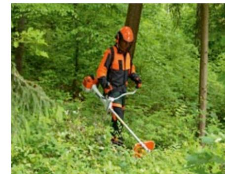
El mantenimiento de determinados tipos de árboles se realiza rápidamente y sin esfuerzo (en la imagen, la desbrozadora STIHL FS 460 C-EM K con sierra circular).
