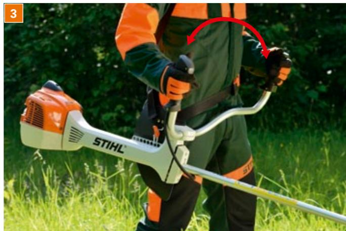
Cuelgue la máquina con el mosquetón en el orificio de anclaje (3). Ajuste el manillar y desplace el mosquetón por los orificios de anclaje hasta que la desbrozadora esté equilibrada (4). Durante los trabajos con cuchilla para matorrales, la herramienta de corte "flota" a poca distancia del suelo, en los trabajos con sierra circular y con tubo corto, la herramienta de corte queda más alta.
