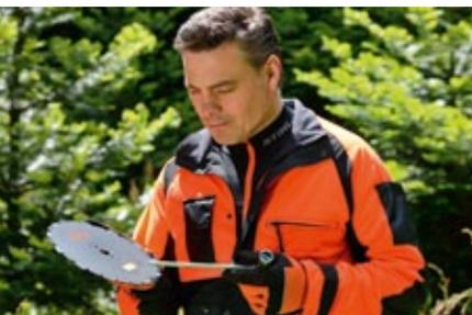
Una herramienta de corte sin roturas suena prolongadamente después de golpearla con un objeto de metal. Hay que comprobar la sierra circular de esta forma en varios puntos de su perímetro.
